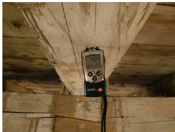
Obr. 19 – Meranie vlhkosti -SN pri B3, +5,250m, 14,2%
