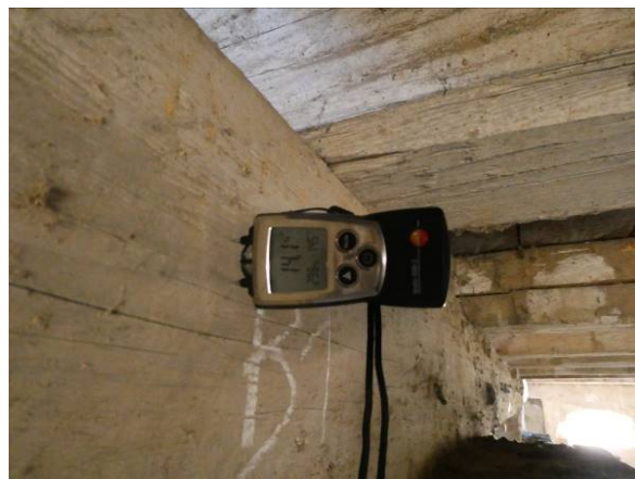
Obr. 13 – Meranie vlhkosti -prievlak pri B1, +2,800m, 14,1%
